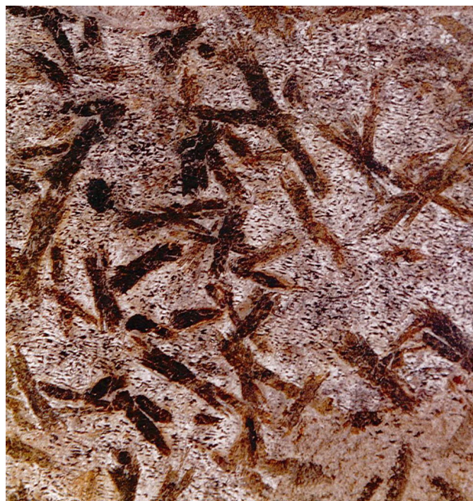
Abb. 12 Wallonerkirche in Magdeburg. Fliese von Wechselburger Garbenschiefer auf der Altarplatte. Ded. Dipl.-Restaurator K. BÖHM, Landesamt für Denkmalpflege und Archäologie Sachsen-Anhalt, Halle. Bildbreite ca. 12 cm.
