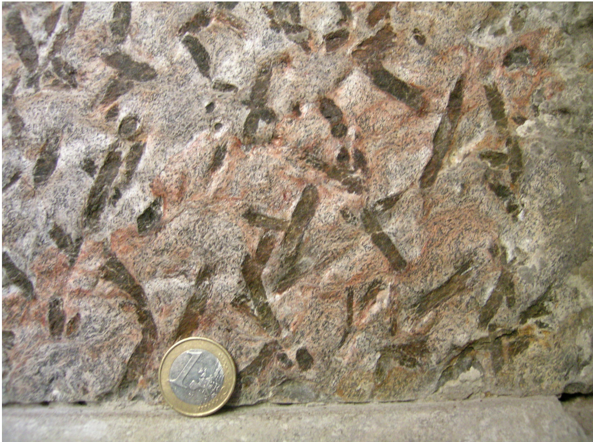
Abb. 11 Naumburger Dom. Wechselburger Garbenschiefer an der Rückwand des Chorgestühls.
